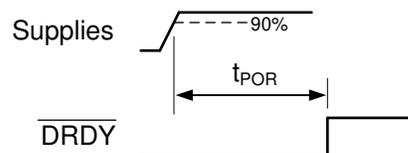
Figure 3. Power-On-Reset Timing
