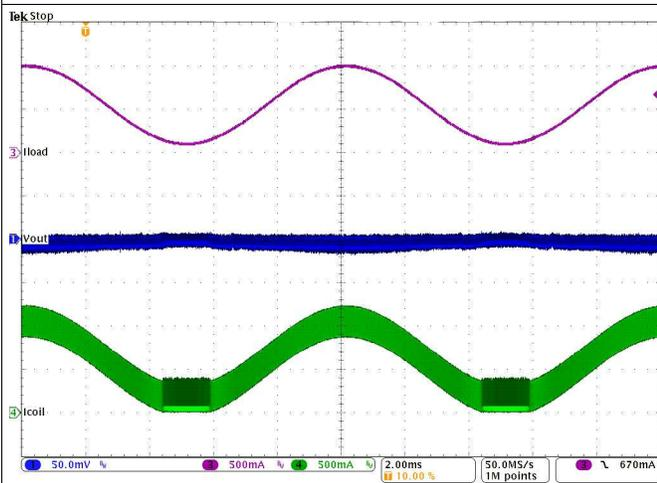
Figure 28. PWM-PSM-Transition
