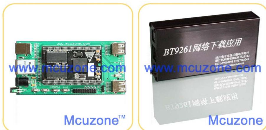
BT9261 网络下载应用开发板是基于 MDK9261 核心板设计的超低价格的 ARM9 linux 学习开发应用板。
