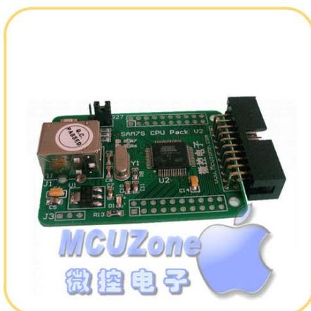
从 USB 口取电，板载 1117-3.3V LDO，连接到 USB 口最小系统即可工作。
