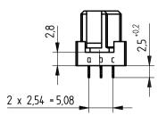
Tauchlötaschluß 0,65 x 0,3 mm / solder terminal 0,65 x 0,3 mm
