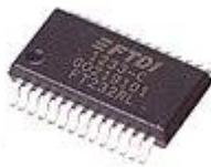
FTDI FT232RL: USB to UART [IC](#) (in [SSOP](#) package)
